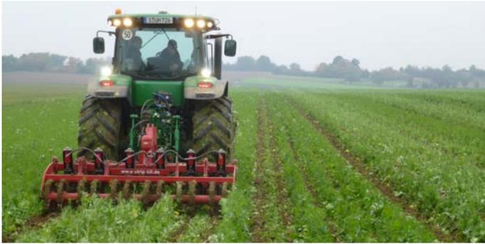
Streifenbearbeitung oder auch Strip-till ist eine Bodenbearbeitungs- und Aussaatmethode vornehmlich für Reihenkulturen, die ein 15 bis 20 cm breites Saatbett schafft und somit zwei Drittel des Ackers unbearbeitet lässt. Die beiden Arbeitsgänge können gleichzeitig oder zeitversetzt im Herbst und Frühjahr stattfinden. Die Intensität der Methode ist variabel und abhängig von der Fruchtfolge und dem Anbausystem.
